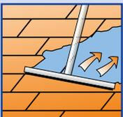
An mehreren Stellen Reinigungserfolg überprüfen. Die Reinigungslösung abziehen oder -saugen<br>
