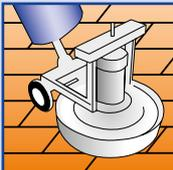
→ Bei größeren Flächen Einscheibenmaschine mit weißem Pad benutzen.<br>■ <b>Wichtig:</b> Es dürfen keine sichtbaren Produktreste auf der Oberfläche antrocknen.                                                                                                                                      |
